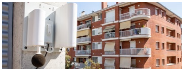
Sensor de ruido instalado en el complejo Podium Viladecans
